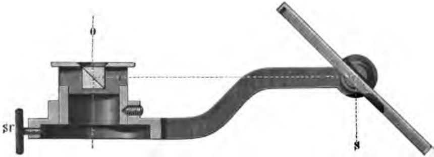
Fig. 24. Camera lucida nach ABBE, in natürl. Grösse. Idealer Längsschnitt. Der Strahlengang durch Linien angegeben. o die Richtung zum Auge, s die Richtung zur Zeichenfläche, sr Klemmschraube.
